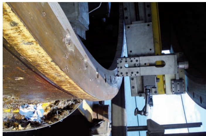
Επιτόπια κατεργασία (πλάνισμα – λείανση), διάμετρος κατεργασίας περίπου 3,6 μέτρα
