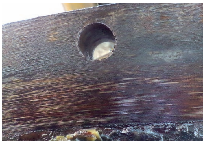
Επιφάνειες φλάντζων πριν την κατεργασία
